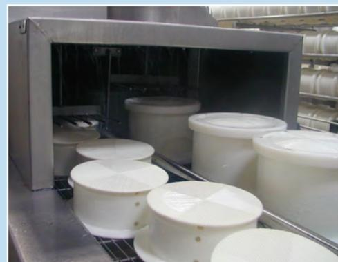
La suciedad presente en los moldes suele ser de dos tipos: por una parte encontramos materia orgánica, como grasa y proteínas, que pueden ser eliminadas con detergentes alcalinos, pero a menudo se aprecia un elevado nivel de incrustación mineral proveniente de las sales minerales de la leche, dureza del agua, aditivos tecnológicos, etc. La suciedad presente en las microperforaciones de los moldes obtura el poro y dificulta el desuerado y el correcto desarrollo del proceso de elaboración.
